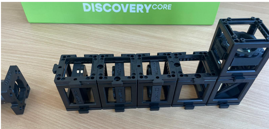
Aufbau: Mikroskop mit Unendlichkeits-Optik
